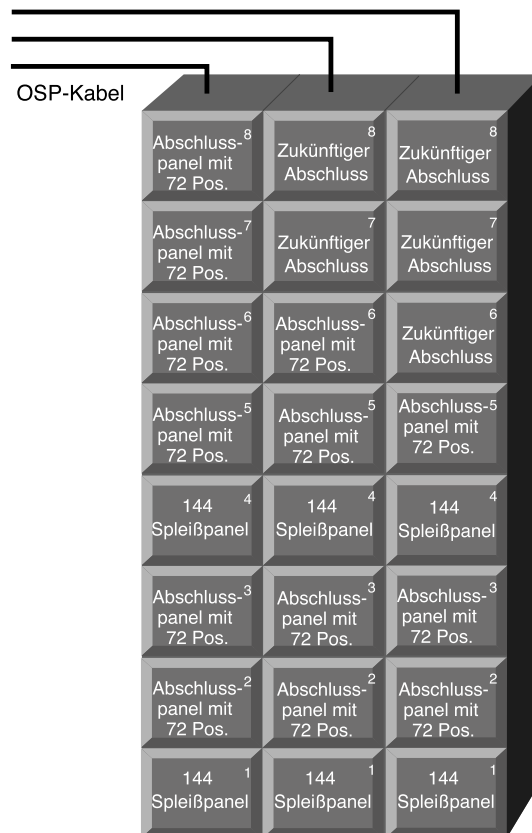
ODF mit Spleiß und Abschlüssen in der Hauptniederlassung. (3) Gestelle, Gesamtkapazität: 1080 Abschlüsse.
